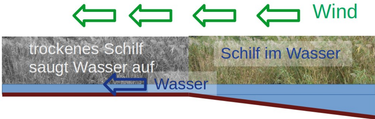
Abb. 6: Durch Windverfrachtungen verlagern sich die Wassermassen und überfluten ausgetrocknete Schilfbereiche. Diese Wassermassen werden aufgesaugt und gehen verloren. Wind: grüne Pfeile, symbolisch
