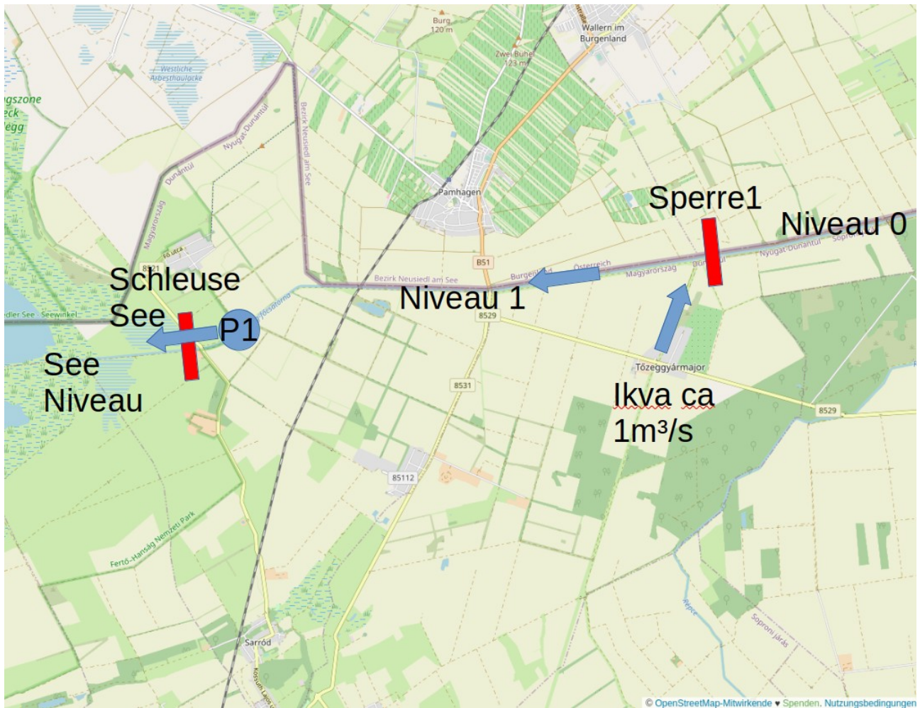
Abb. 3: Beispiel (Detailplanung erforderlich) Rückleiten und Anheben von Ikva Wasser in den See. Sperre 1 zB aus Spundwänden würde den Pegel um mehrere Meter heben, von Niveau 0 auf Niveau 1. Die Distanz bis zur Schleuse des Neusiedlersees ist ca 9 km, das Gefälle ist jedoch sehr gering. Es gilt abzuklären, ob bis zur Schleuse vom See noch weitere Sperren und Hebewerke notwendig wären, der Vereinfachung halber wurde diese in der Illustration weggelassen. Ein provisorisches, siehe Abb.1 oder fix installiertes Pumpwerk P1 würde das Wasser von Niveau 1 auf See Niveau bringen. Bei Bedenken zur Wasserqualität der Ikva, siehe 2.1.
