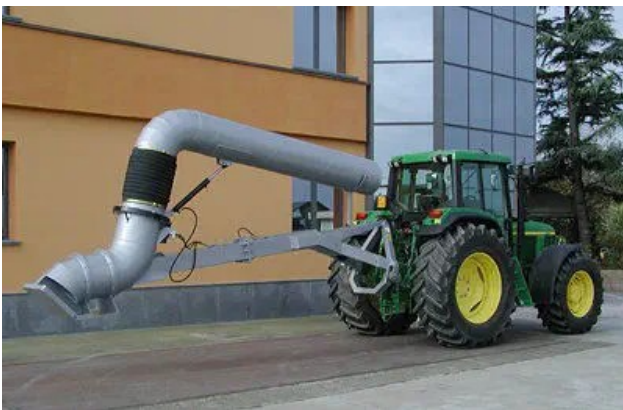
Abb. 1: mobile Zapfwellen-Pumpe ca 1\text{m}^3/\text{s} https://www.agriexpo.online/de/prod/veneroni-srl/product-179780-48846.html
