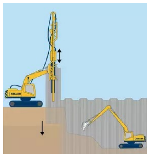
Abb. 2: Beispiel Spundwände einschlagen Grafik: keller-france.com
