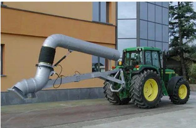
Abb. 1: mobile Zapfwellen-Pumpe ca  $1\text{m}^3/\text{s}$
