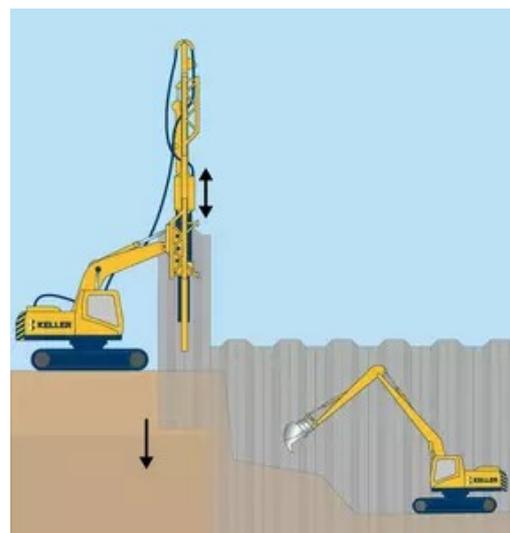
Abb. 2: Beispiel Spundwände einschlagen
